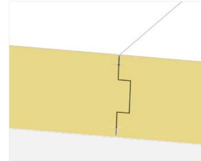
Das Einschäumen der Dichtung verhindert ein Herauswandern der Dichtung, besonders bei Verwendung der Kühlzelle im Wechseltemperaturbereich und bietet zusätzlich einen ausgezeichneten Korrosionsschutz. Aus hygienischen Gründen erfolgt die Stoßausbildung aller Blechdeckschichten als optisch kontrollierbare C-Blechabkantung.
