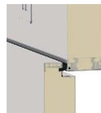
Leicht auswechselbare Moosgummidichtung und doppellippige Schleifdichtung
